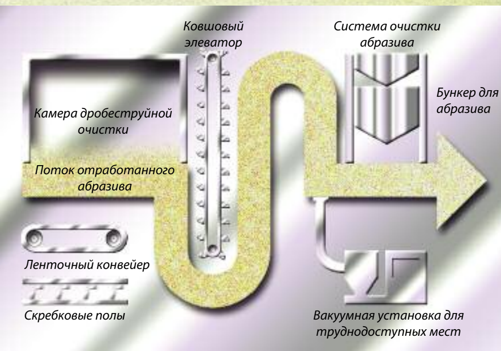
Стационарная система сбора и очистки абразива Munkebo
